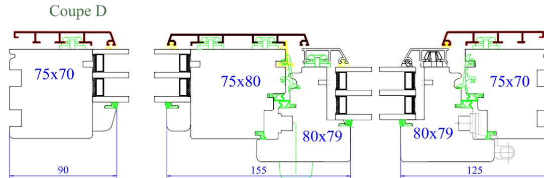
Coupe verticale d'un raccord horizontal pour faciliter le transport
